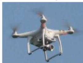
UAV(ドローン等)による3次元測量
